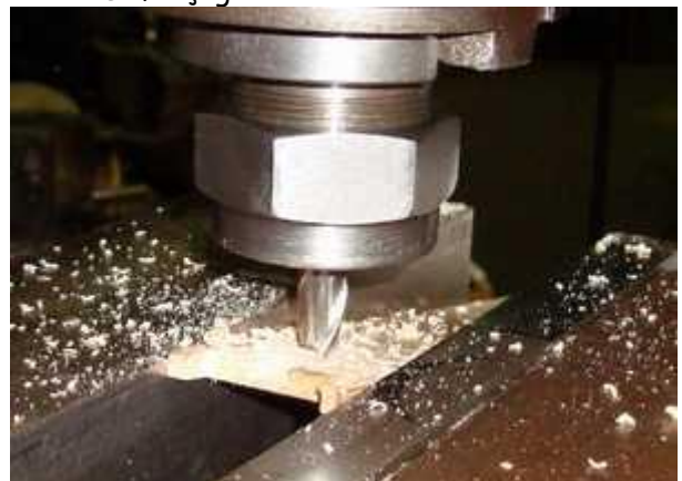
Usinage de la pente
