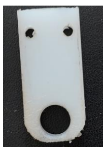
4 supports mobiles pour les rouleaux.
