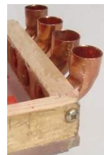
Entrée de l'air de part et d'autres sur les côtés de la boite à soupapes
