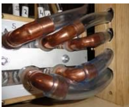
Raccords coudés sur la boîte à soupapes
