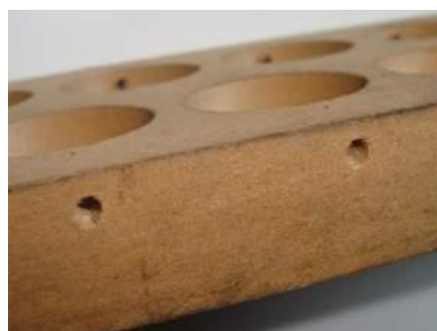
Perçages sur la tranche inférieure Petit trou = vis de réglage
