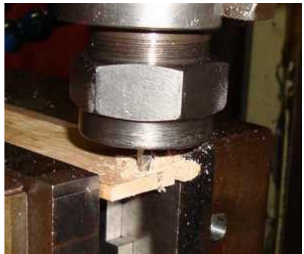
Défonçage de la hauteur de bouche
