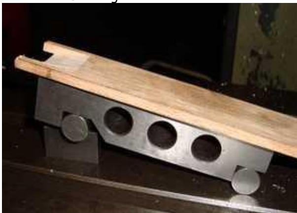
Calage de la latte sur une « barre à sinus » pour maintenir un axe horizontal de la fraise
