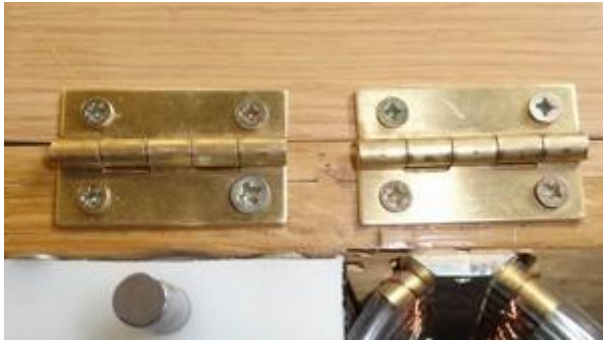
Fixation sur l'arrière par 2 mini charnières
