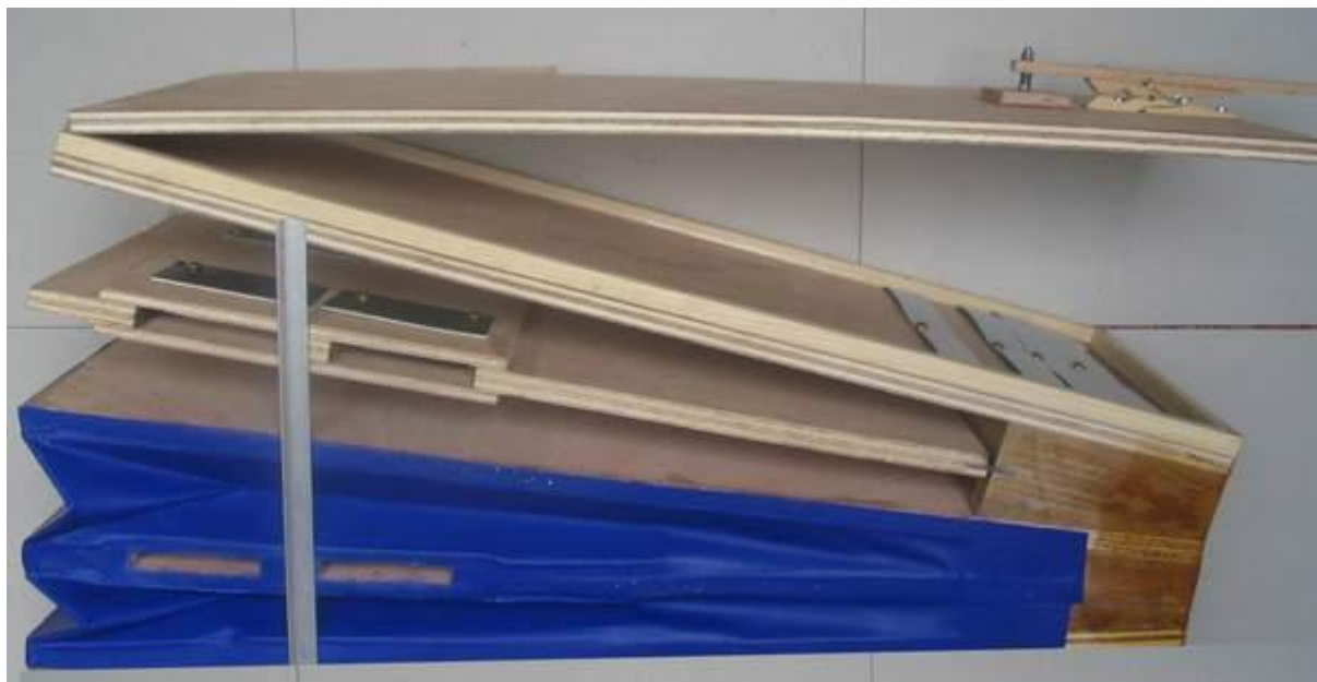
Photo de la soufflerie à moitié garnie des peaux (cela permet de voir l'intérieur)
