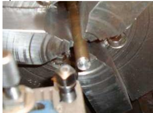
Tour pour dressage et chanfreinage des extrémités
