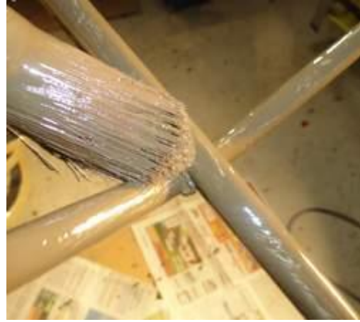
Deux couches de peinture de la bonne couleur souhaitée. Il est certain qu'avec un pistolet, ce serait plus facile, et mieux fait.
