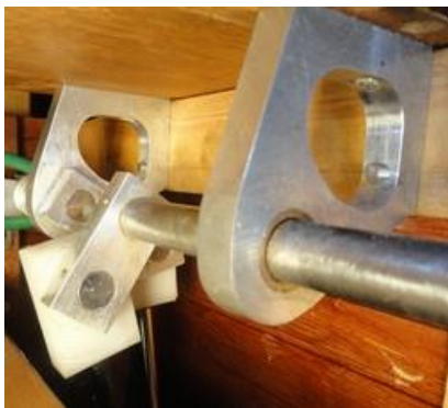
Vue du vilebrequin complet et des paliers sur l'orgue n° 2.
