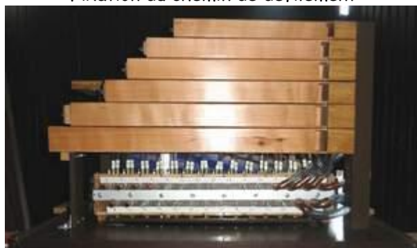
Mise en place des flûtes horizontales
