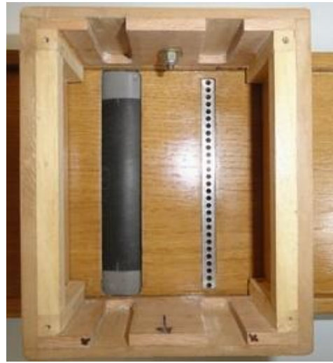
Avant de mettre en place les charnières, bien aligner la boîte pour que l'axe du rouleau cannelé soit très légèrement en amont de l'axe de la flûte de pan
