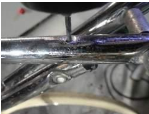
La tubulure horizontale est percée pour recevoir des vis.
