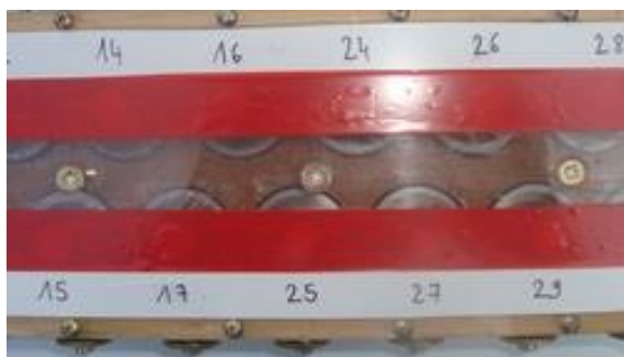
Occultation des trous du couvercle par des bandes de scotch.
