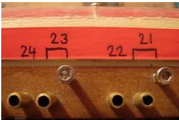
Marquage des arrivées de la flûte de pan et des vis de réglage (vitesse de répétition)
