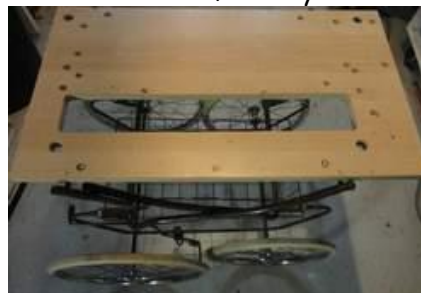
La base est ajourée pour laisser accès aux vis de réglage de butée des soupapes
