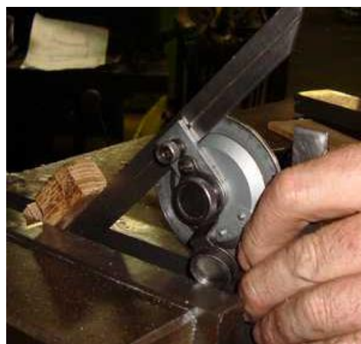
Calage dans l'étau avec un rapporteur d'angle
