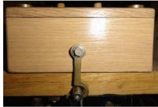
Un loqueteau est fixé sur la face avant pour assurer le placage des rouleaux sur le carton.
