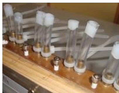
Occultation des tubes avec des bouchons (tuyau cristal + bouchon de colle au pistolet)
