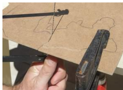
Découpe à la scie à chantourner
