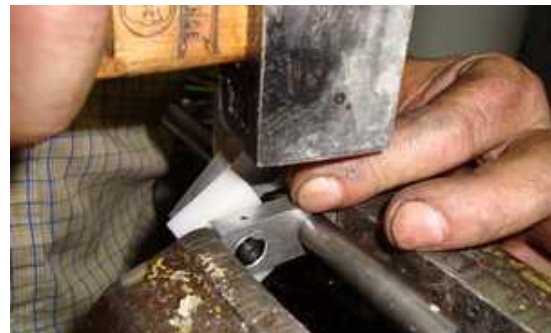
Tour pour dressage et chanfreinage des extrémités
