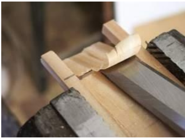
A l'ancienne, au ciseau à bois. Là, il faut être un pro (n'est-ce pas Pierre...)
