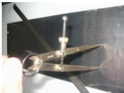
Traçage de la forme sur la plaque d'aluminium
