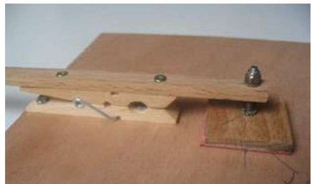
Croquis et photo du clapet de la réserve
