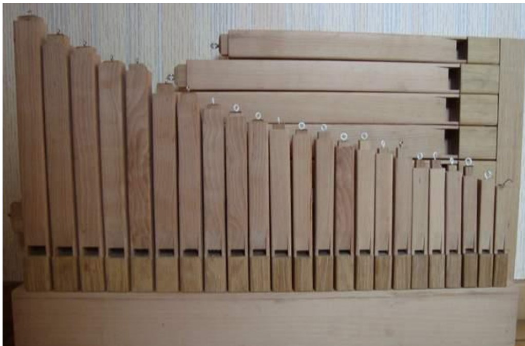
Disposition retenue pour l'orgue n° 1 (Après les opérations d'accordage, les pitons disgracieux seront dissimulés et l'ensemble sera verni)
