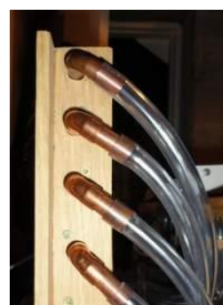
Raccords coudés au pied des flûtes sur la table verticale
